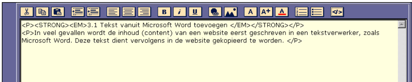
Figuur 3.5 HTML-code van tekst dat via Kladblok/Notepad naar de text-editor is gekopieerd
